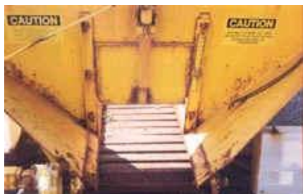
Опрыскиватель после одного сезона при прямом применение соли
